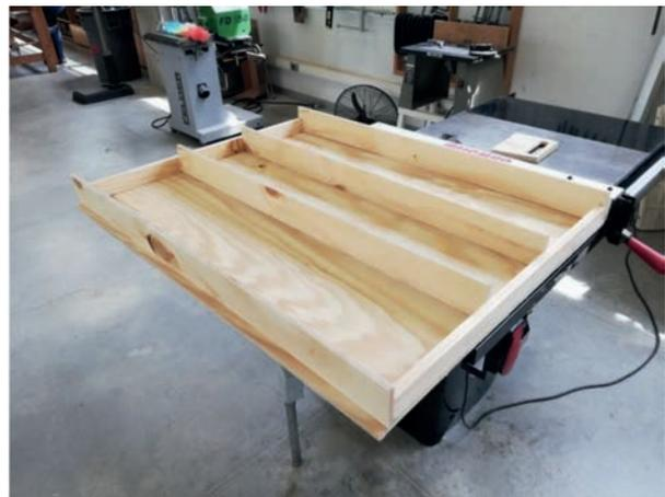
Entre los observables, se encontró que los perfiles de madera en el mercado no conservan una estandarización de las secciones, los diferentes aserraderos pueden cambiar las medidas de sus perfiles, por lo que generar un diseño de cimbra fijo no es lo conveniente; el diseño anterior debe considerar su adecuación a los perfiles del elemento constructivo a colar.
