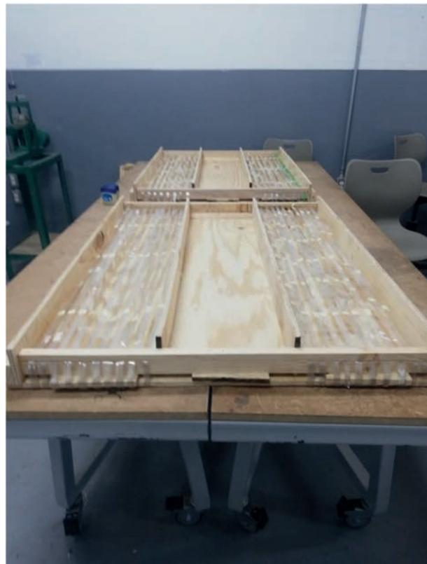
cluir tiras de PET de manera longitudinal a través de la prueba de flexión con dos puntos de apoyo y fuerza aplicada al centro.
