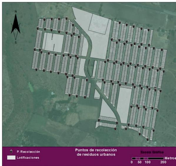
FIGURA 14. Plano de la dotación proyectada de contenedores. Elaboración propia.
