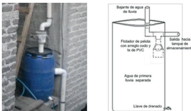
FIGURA 19. Separador de primeras aguas. Fuente: García, 2012.
