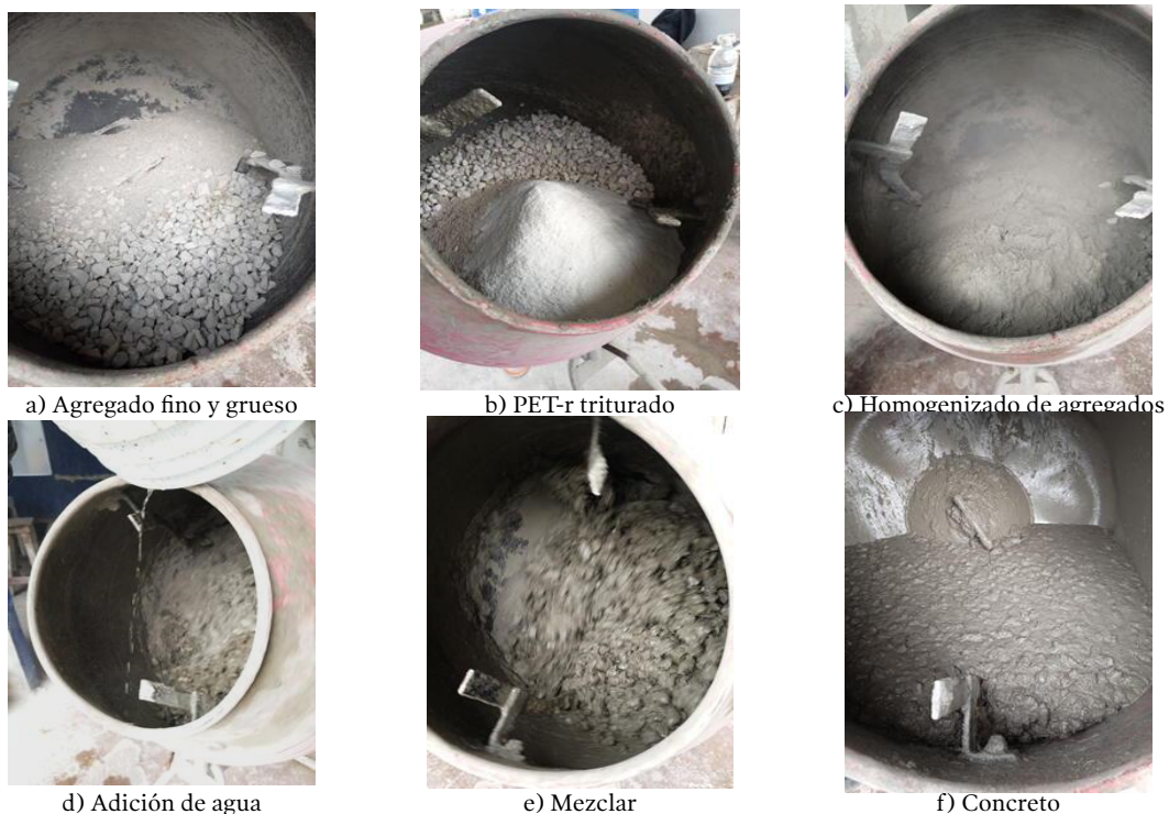
Figura 3 Proceso de elaboración de concreto modificado para el diseño PET-r triturado
