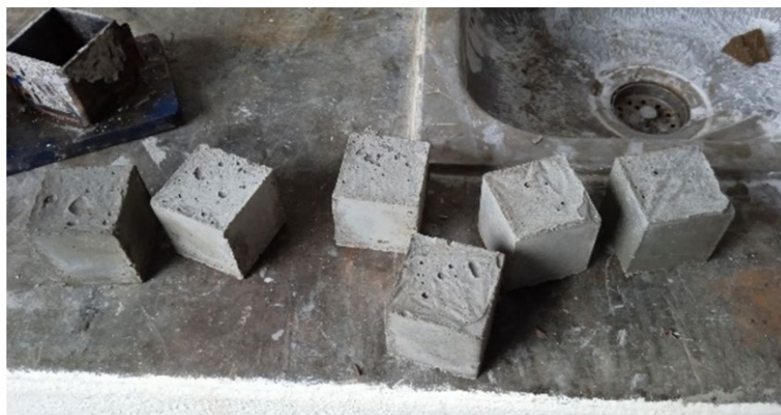
Figura 4 Probetas de mortero de 5 cm de lado
